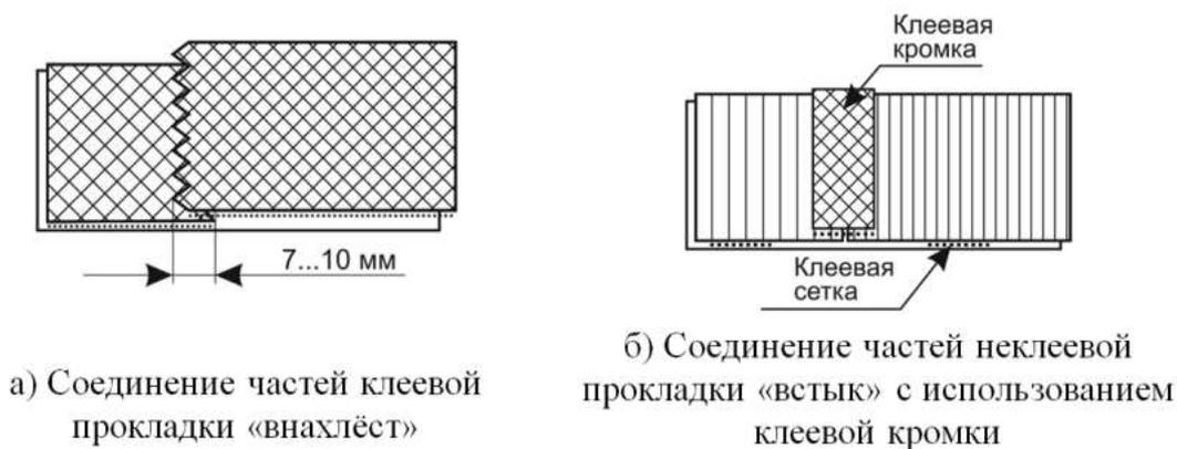
**Рисунок 8 – Соединение надставок прокладочного материала**
